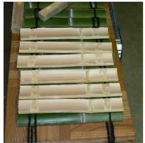
助手がいれば編み易いが、年末のことで一人仕事。編み台は洗車用の脚立に長い合板を載せて代用。端には簾端を揃えるため棧木を万力で止める。棕櫚縄を3本ずつ脚立の梯子部に括り、竹片を編み込んでゆく。このとき反対側の引張りが必要なので棕櫚縄の反対側には錘(おもり)をぶら下げる。ここでは錘に石頭(せつとう)を使用。
