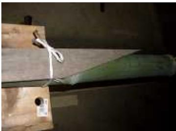
位の幅で適当な長さに切り、角度を決めて片端を斜めに切り落とす。この定規を竹にくくりつけ、定規の斜め部に沿って竹を切る。(左写真)
