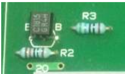
図4 Tr1取り付け状態(上から)
