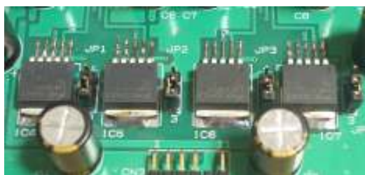
バッファIC周り取り付け例
