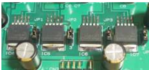
図13 JP1～JP4周辺 (ジャンパ及びオプションの バッファIC取り付け状態)
