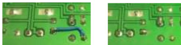
図21 C30コンデンサ修正例
