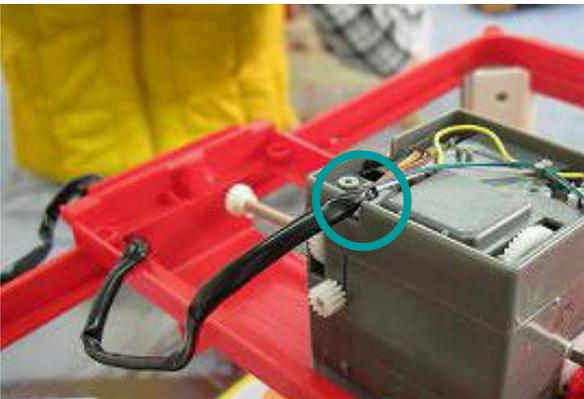
⑮黒いケーブルの端がギヤボックスの端にあるか確認。ギヤボックスの移動範囲に支障がないかケーブルの長さやねじれを確認し、赤い蓋を取り付ける。リミットスイッチにより動作が制御されているので、必ず赤い蓋を取り付けて試運転を行う。
