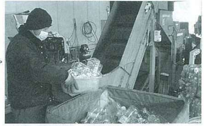
職員がチェックをしながら圧縮梱包機に投入します。
